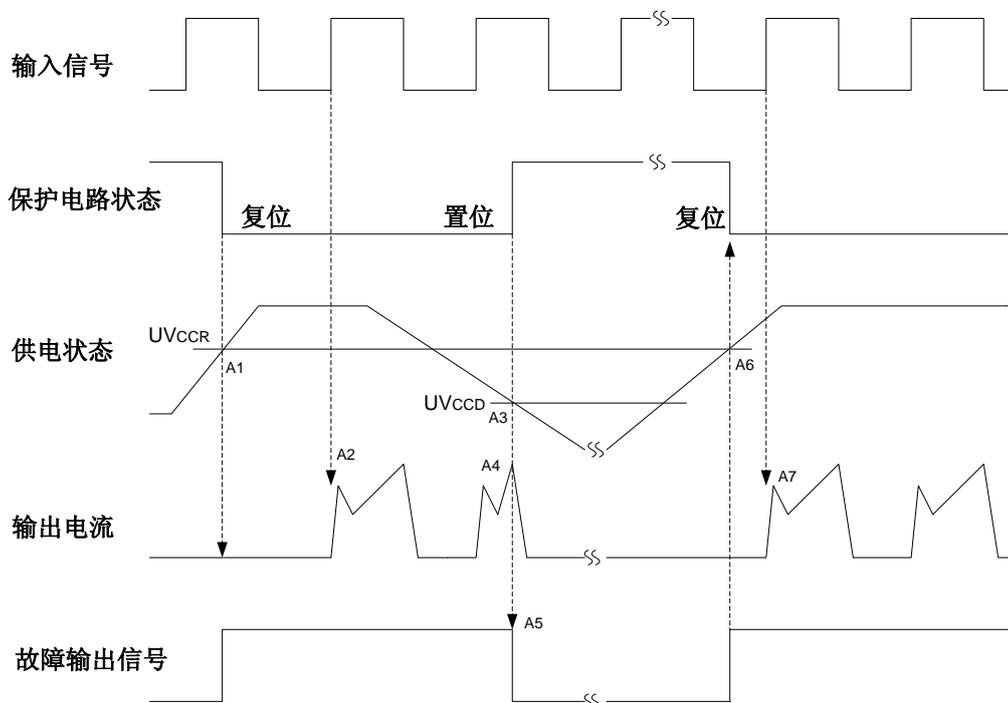
A1：供电电压上升至  $UV_{CCR}$ ，当下一个输入波形到来时电路开始工作；
